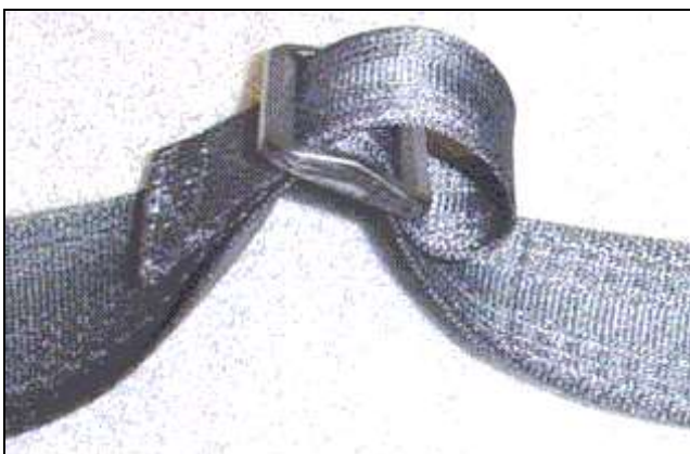
Figure 35-B : Empêcher le désajustement de la ceinture.
