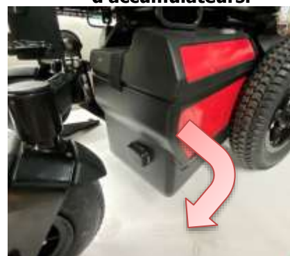
Figure 12 : Retirer complètement le compartiment d'accumulateurs.
