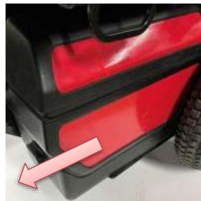
Figure 11 : Retirer les compartiments d'accumulateurs.
