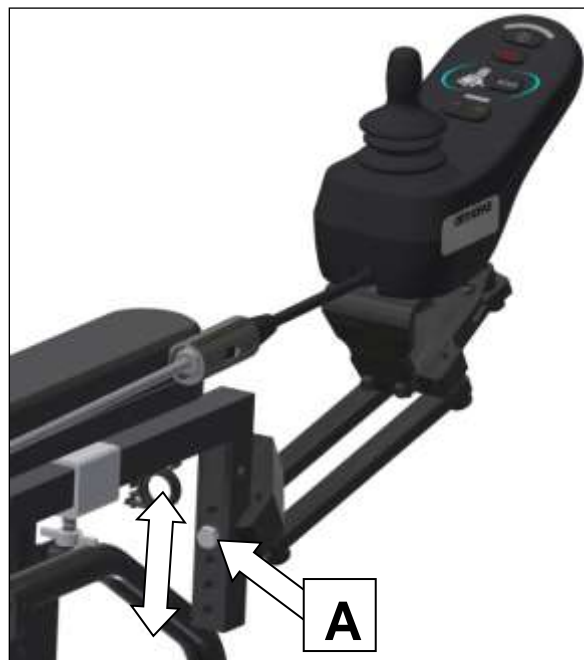
Figure 27 : Ajustement en hauteur du support du boîtier de commande.
