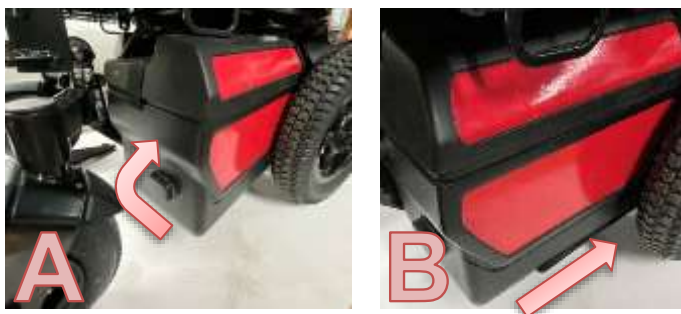
Figure 17 : Remise en place du compartiment
