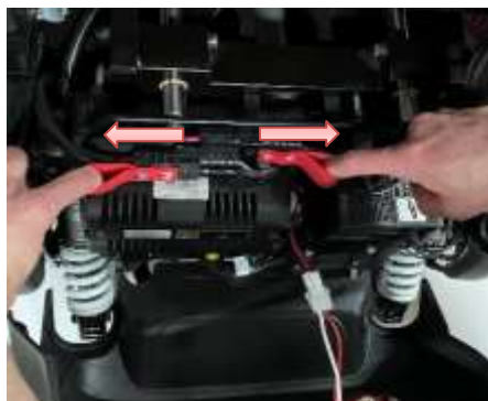
Figure 9 : Déconnecter les accumulateurs.
