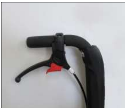
Figure 1: Manette de désengagement des freins.
