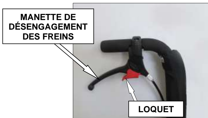
Figure 37 : Manette de débrayage des freins.
