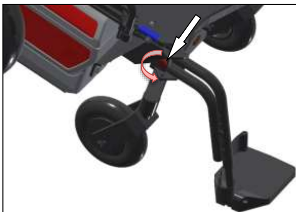
Figure 29-A : Escamotage des appuie-jambes.
