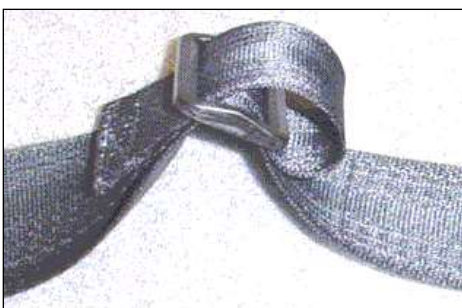
Figure 36 : Comment prévenir le désajustement de la ceinture.
